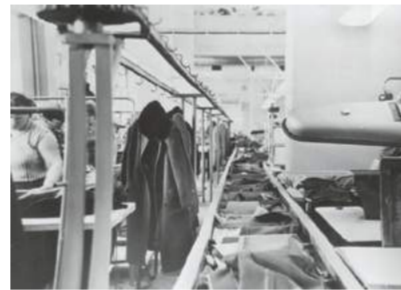
Производственное объединение швейных предприятий «Маяк», цех № 1. Отделочная сениция. Транспортер подачи готовой продукции на приемку. 1967 год
